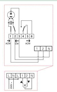
Servomotore cod. 637012 (SM100) con regolatore climatico digitale Optimiser® cod. 152001
